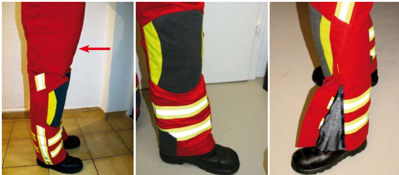
links: In der Balgtasche (Pfeil) wird die Flammenschutzhaube mitgeführt. Die Warnbestreifung wurde im Kniebereich aus Gründen der Beweglichkeit ausgespart. mitte: Die Beininnenseite und das Knie sind mit Silikon-Kevlar-Besätzen gegen Abrieb geschützt. rechts: Reißverschluss am Beinende
